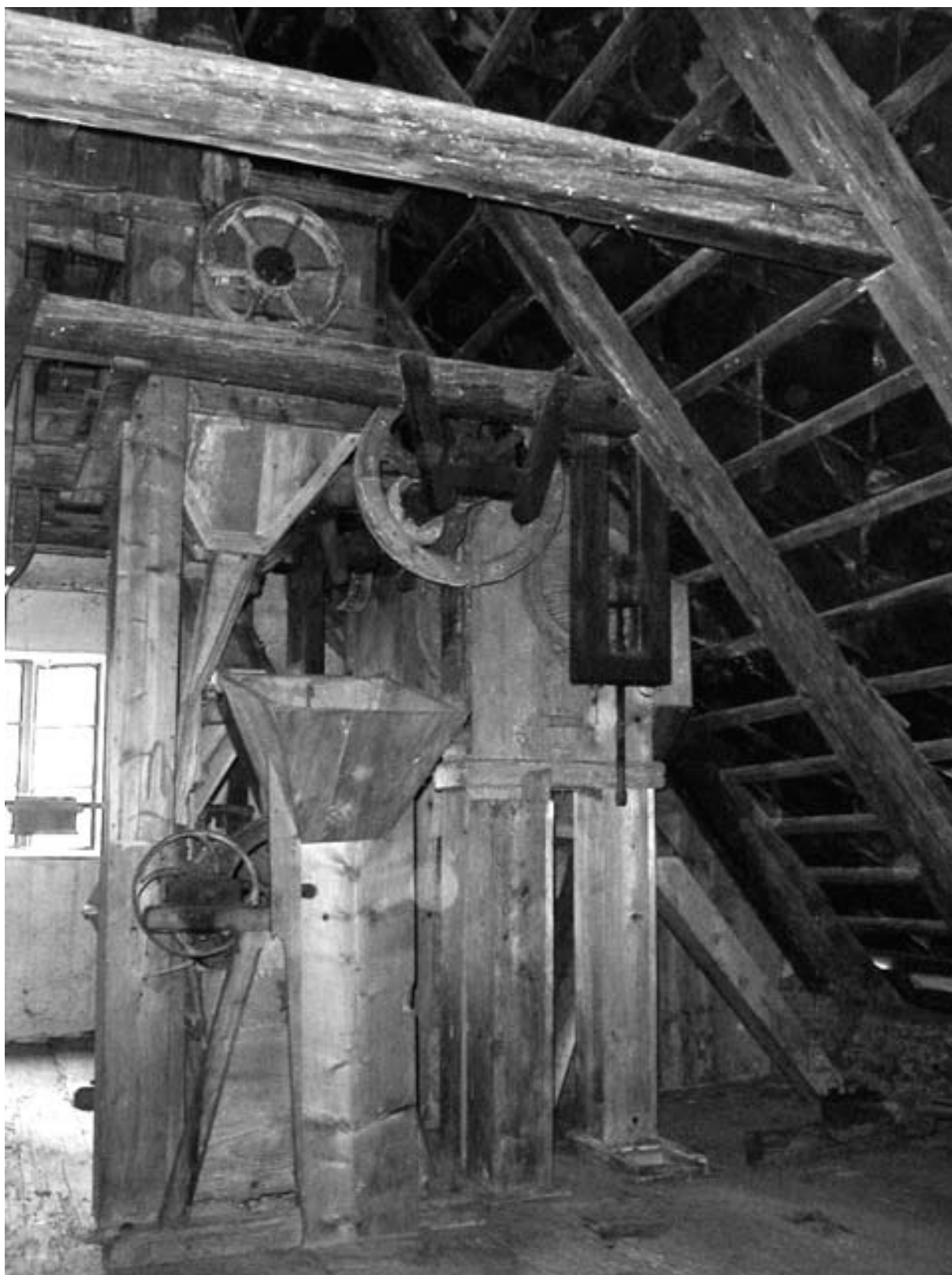
Obr. 5 - Mlýn Wesselsky, Odry – Loučky, násypníky v krovu mlýna. Foto J. Novosad, 2002.
