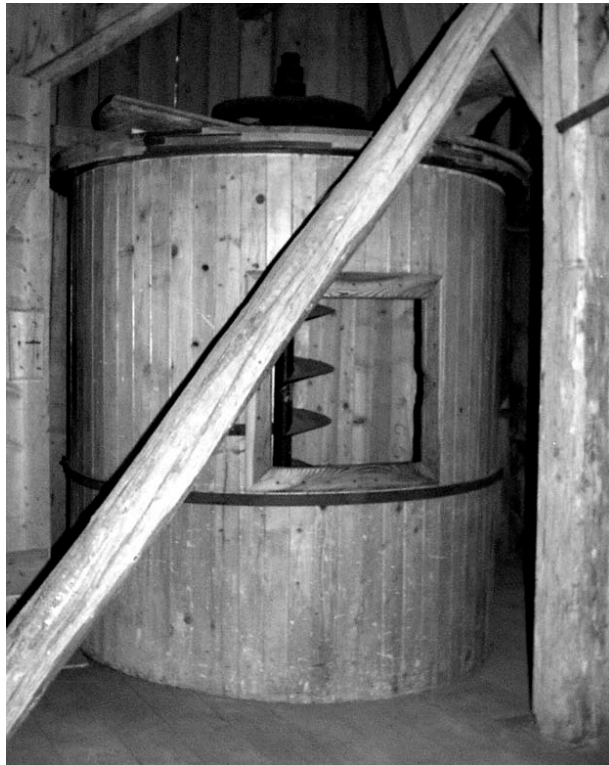
Obr. 12 - Vertikální šneková míchačka mouky – řez. Vlevo je patrný násyp přes násypný koš.
