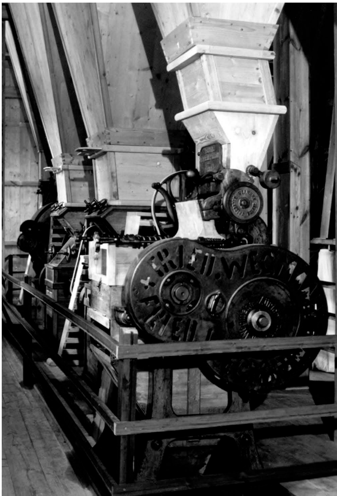
Obr. 6 - Válcová podlaha mlýna – v popředí stolice fy Wegmann, za ní dvojice stolic fy Breitfeld-Daněk, současný stav. Foto E. Řezáčová, 2000.
