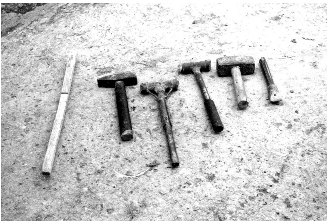
Obr. 7 - Svatá Helena, župa Caras Severin. Nástroje používané k výrobě mlýnských kamenů. Zleva segmentová šablona, kladivo, dvě sekací kladiva vyrobená z hlavic hornických vrtáků, palice a plochý sekáč s ozubeným ostřím. Foto R. Urbánek, 1997.
