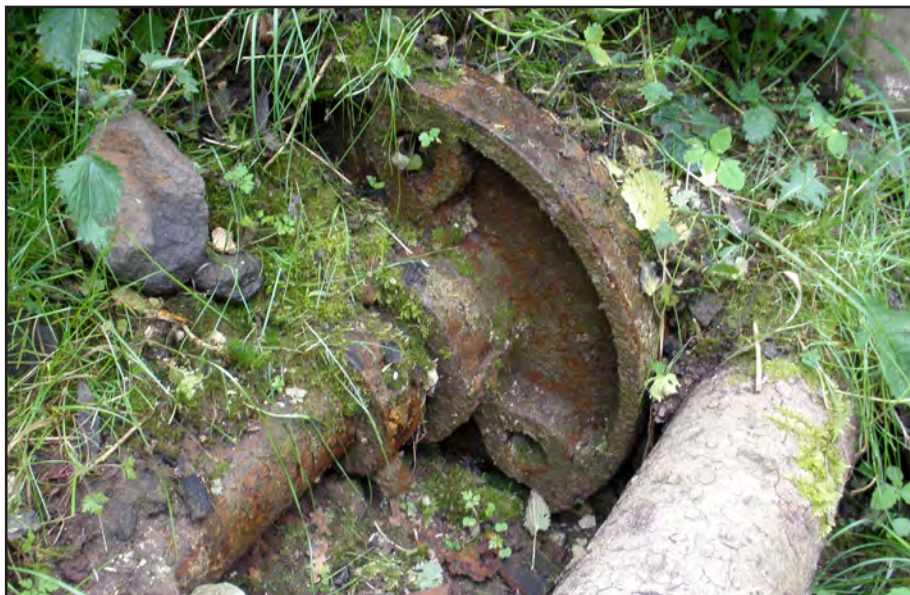
Obr. 5 Týniště (okr. Ústí nad Labem), pila u mlýna čp. 28. Excentr na konci hřídele. Foto František Ledvinka, 2008.
