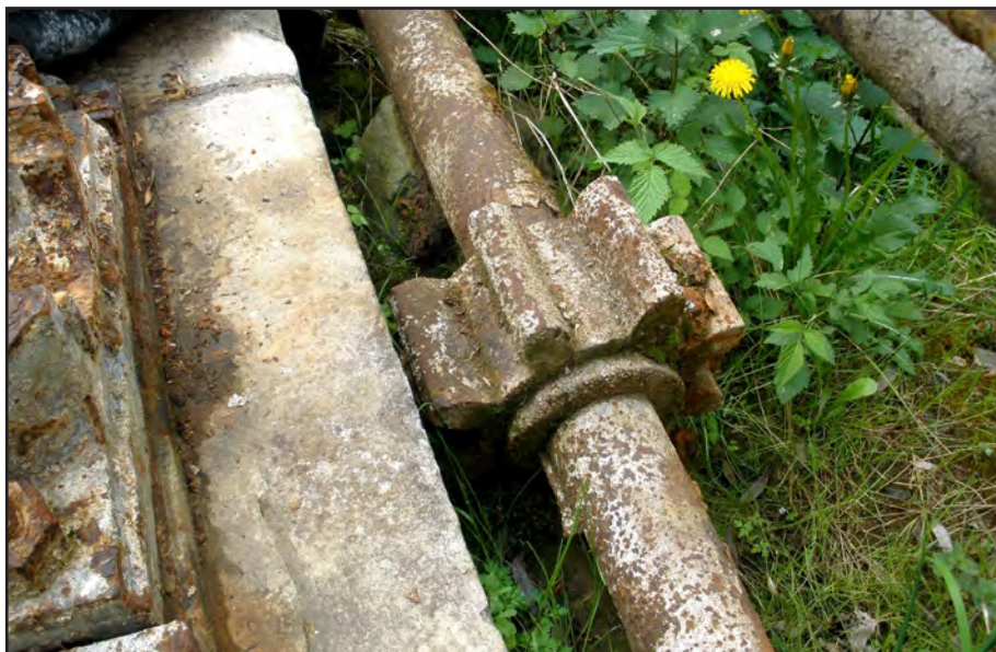
Obr. 4 Týniště (okr. Ústí nad Labem), pila u mlýna čp. 28. Ozubené kolo na převodové hřídeli. Foto František Ledvinka, 2008
