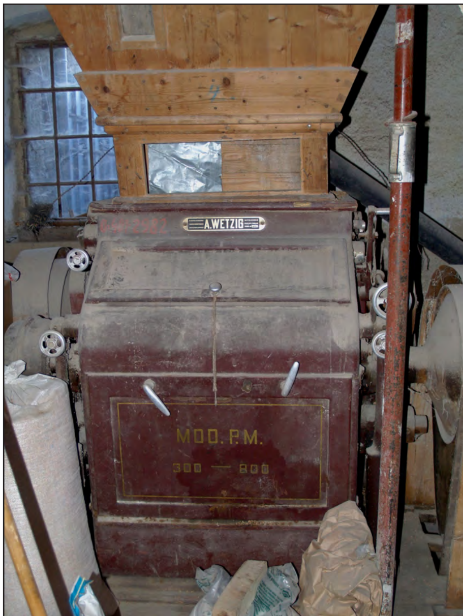
Obr. 4 Týniště (okr. Karlovy Vary), mlýn čp. 23. Válcová mlecí stolice. Foto Jan Konůpek, 2005.
