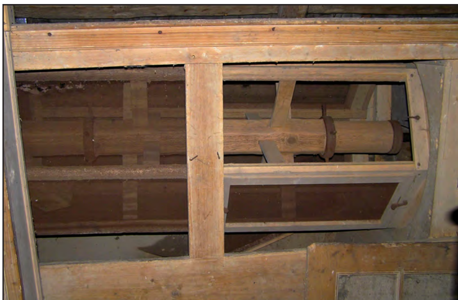
Obr. 3 Roztoky u Semil (okr. Semily), mlýn čp. 44. Čistírenský hranolový vysévač s drátěným potahem. Foto Radim Urbánek, 2006.
