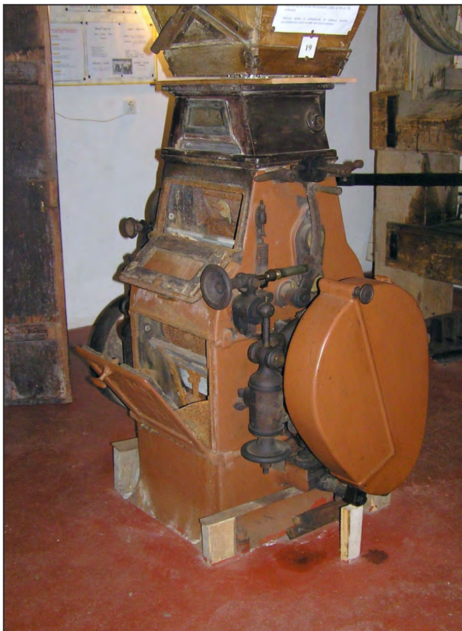
Obr. 5 Roztoky u Semil (okr. Semily), mlýn čp. 44. Jednopárová válcová mlecí stolice v litinové skříňi. Foto Radim Urbánek, 2006.
