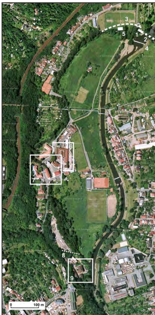
Obr. 10 Fotomapa Cacovického ostrova, 1 – stavebními pracemi zachycená část staršího jezu, 2 – předpokládaný průběh staršího jezu, 3 – předpokládaný průběh mlýnského náhonu v období existence staršího jezu, 4 – současný jez, 5 – poloha valchy, 6 – prostor Cacovického dvora, 7 – Cacovický mlýn, 8 – ústí 2,8 km dlouhé štoly vedoucí vodu říčky Ponávky, 9 – areál bývalého měděného hamru, později koželužny. Podklad – www.mapy.cz , úprava Ondřej Merta.
