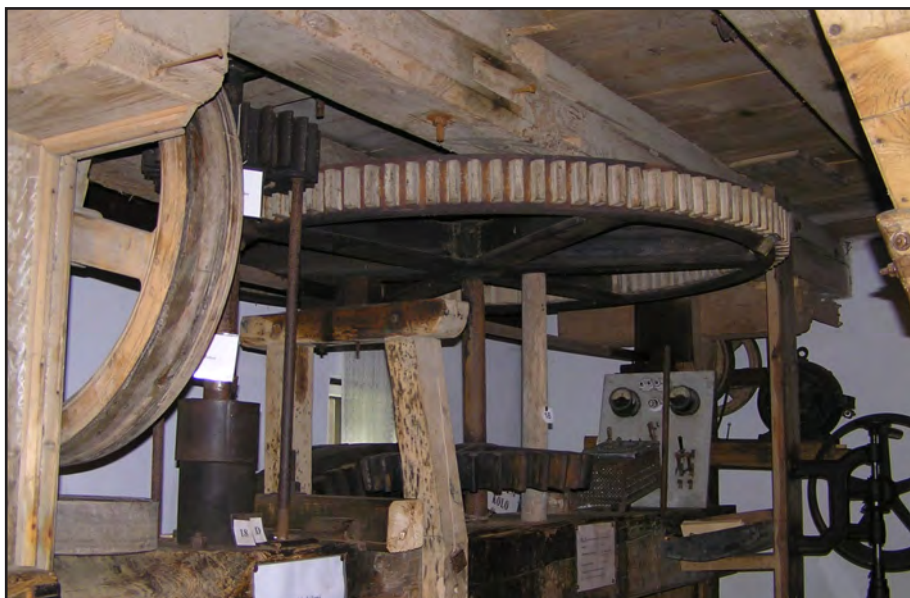
Obr. 2 Roztoky u Semil (okr. Semily), mlýn čp. 44. Výstroj s vloženým hřídelem „na hever“. Foto Radim Urbánek, 2006.
