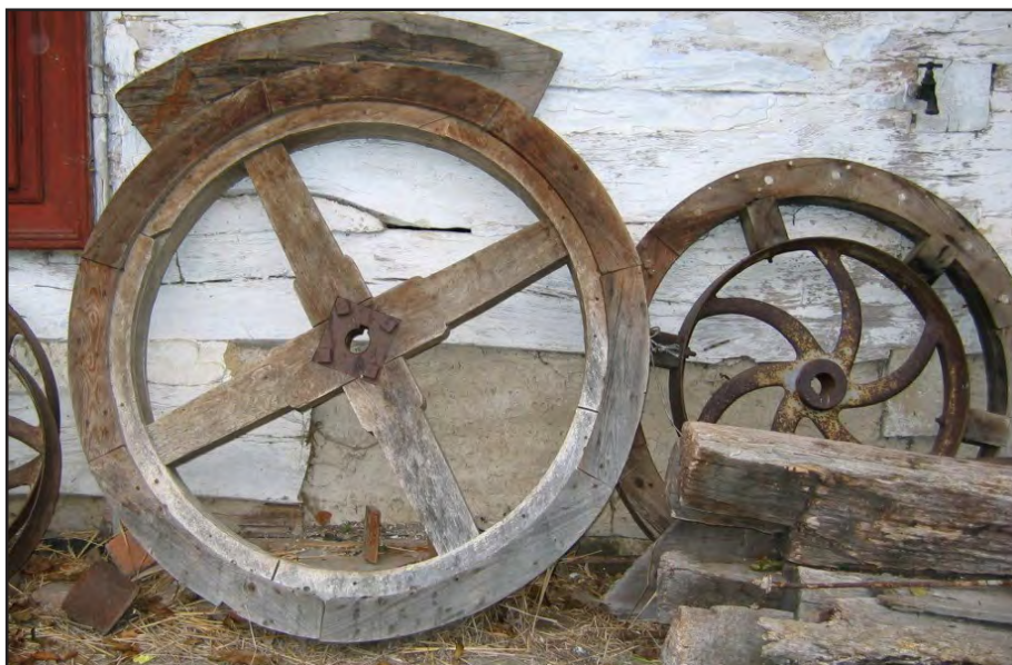
Obr. 8 Psenice (okr. Jičín), mlýn čp. 48. Vlevo dřevěná řemenice, vpravo litinová řemenice upravená na větší průměr. Foto Milan Smolík, 2004.
