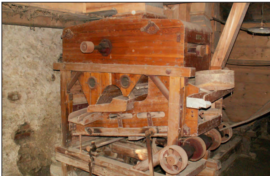
Obr. 2 Sepekov (okr. Písek), vodní mlýn zvaný Farka. Aspiratér na čištění zrna. Foto Eduard Šittler, 2006.
