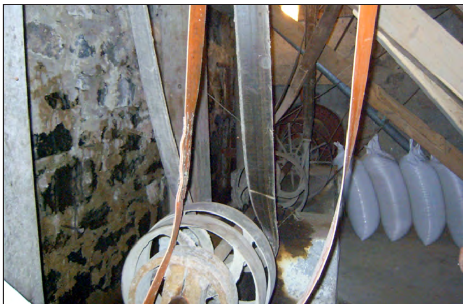
Obr. 3 Týniště (okr. Karlovy Vary), mlýn čp. 23. Transmise s litinovými řemenicemi a jednou řemenicí dřevěnou. Foto Jan Konůpek, 2005.
