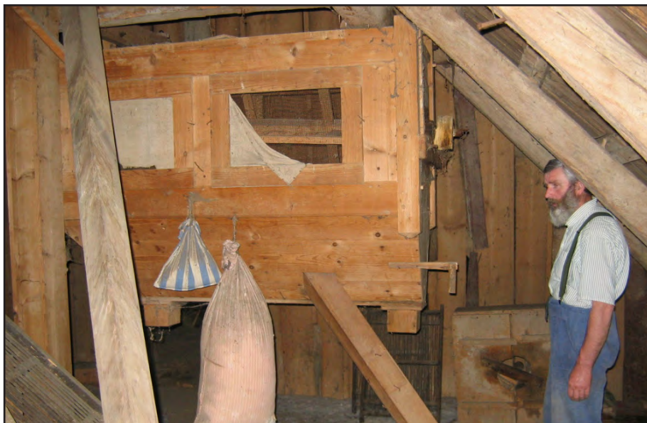
Obr. 7 Psenice (okr. Jičín), mlýn čp. 48. Čistící hranolový vysévač. Vpravo od něj otec vlastníka, p. Jaroslav Kinský starší. Foto Milan Smolík, 2004.
