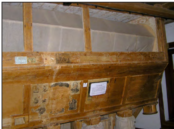
Obr. 6 Roztoky u Semil (okr. Semily), mlýn čp. 44. Moučný hranolový vysévač. Foto Radim Urbánek, 2006.
