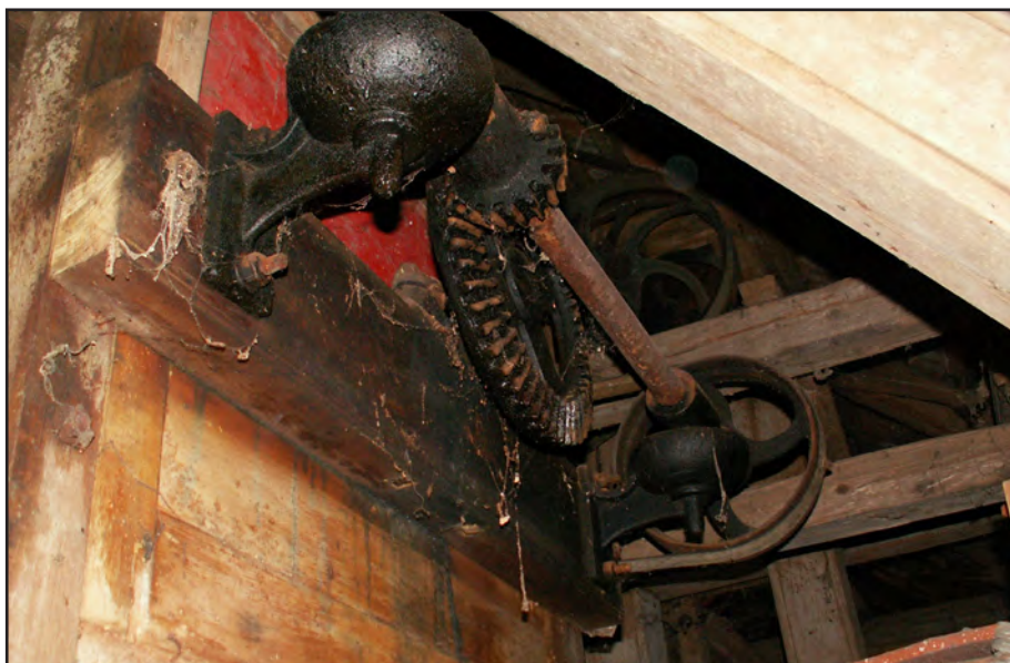
Obr. 3 Sepekov (okr. Písek), vodní mlýn zvaný Farka. Převody hranolového vysévače. Foto Eduard Šittler, 2006.
