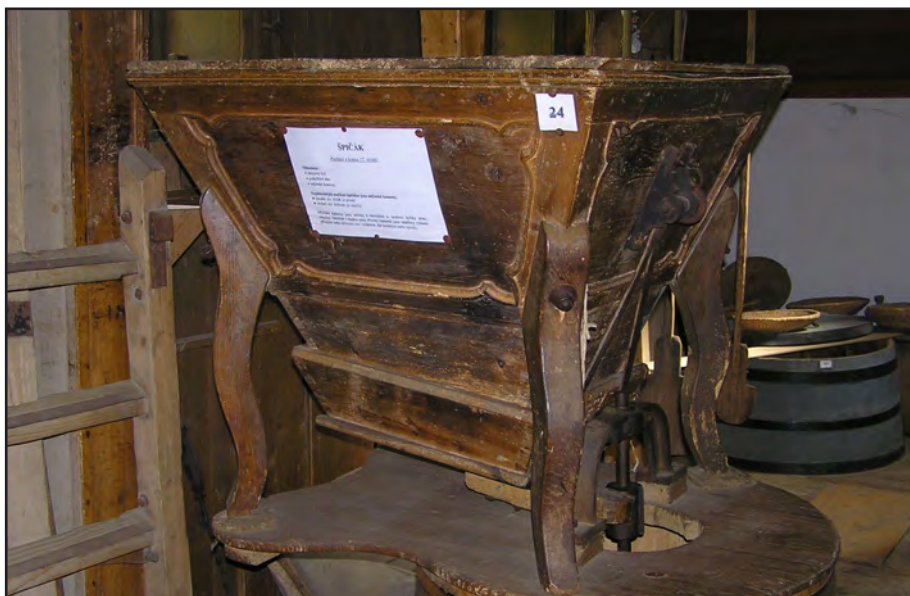
Obr. 4 Roztoky u Semil (okr. Semily), mlýn čp. 44. Násypný koš nad složením mlecích kamenů. Foto Radim Urbánek, 2006.
