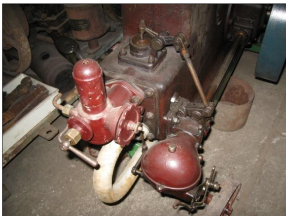
Obr. č. 22 a 23 - benzínový čtyřtakt, 4 HP, rok 1925, zapalování rotační magnetkou. Foto: Václav Medek, 2013.
