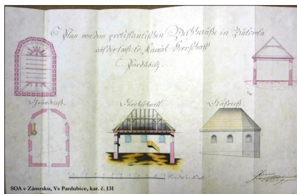
Obr. č. 11. Výkres dřevěné toleranční modlitebny v Bukovce (SOA v Zámrsku, Velkostatek Pardubice, kar. č. 131).
