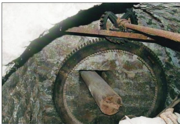
Obr. č. 21. Smržovka (okres Jablonec nad Nisou), brusírna čp. 85, litinový ozubený převod čelní od vodního kola na transmisi. Foto: David Veverka, 2009.
