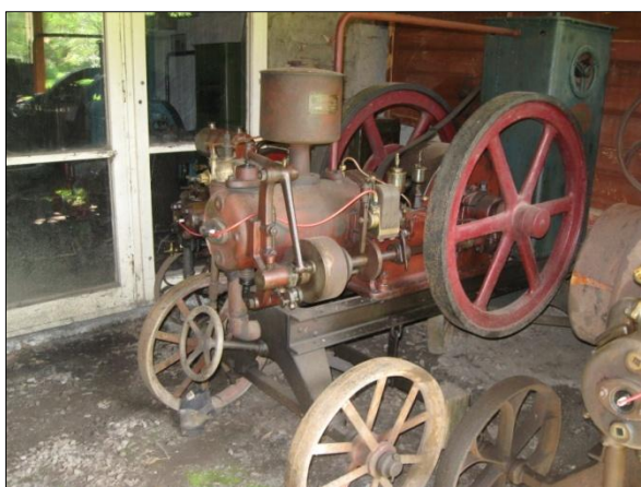
Obr. č. 7. Odrhové zapalování vysokonapětové - motor LORENZ, čtyřtákní, benzínový, 5-7 HP, rok 1925. Foto: Václav Medek, 2013.
