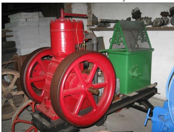
Obr. č. 19 - benzinový čtyřtakt, 8-10 HP, rok 1930. Foto: Václav Medek, 2013.
