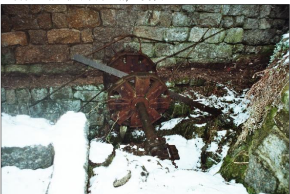
Obr. č. 11. Josefův Důl (okres Jablonec nad Nisou), brusírna čp. 701, kovová hřídel s disky (rozeta) vodního kola. Foto: David Veverka, 2009.
