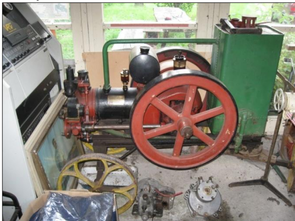
Obr. č. 47 - benzínový čtyřtakt, rok 1925-27, zapalování odtrhové, vysokonapět'ové se zapalovací svíčkou. Foto: Václav Medek, 2013.
