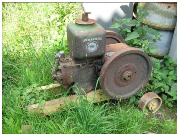
Obr. č. 45 - benzínový čtyřtakt, 3-4 HP, rok 1930, zapalování rotační magnetkou. Foto: Václav Medek, 2013.
