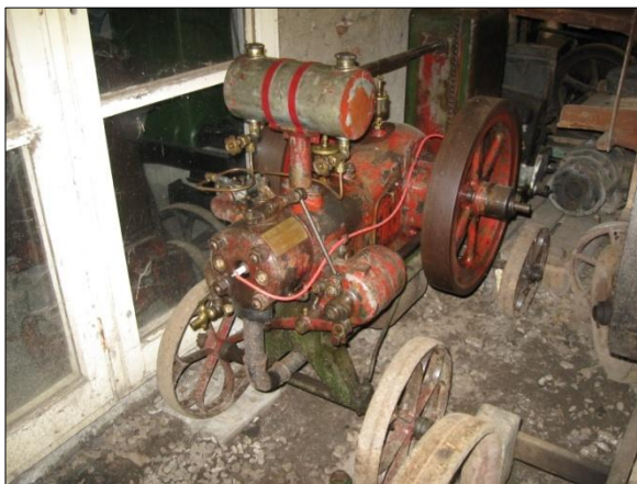
↑Obr. č. 24 - benzínový čtyřtakt, 4 HP, rok 1920, zapalování odtrhové, vysokonapěťové. Foto: Václav Medek, 2013.
