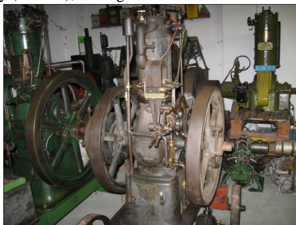
Obr. č. 31 a 32 - benzinový čtyřtakt, 3 HP, rok 1905-1910, zapalování odtrhové, nízkonapětové. Motor má automatický sací ventil - mechanicky je pomocí vahadla ovládán pouze výfukový ventil. Sací ventil má slabou pružinu a je ovládán podtlakem při sání. Foto: Václav Medek, 2013. Jedinečný, výborný motor.
