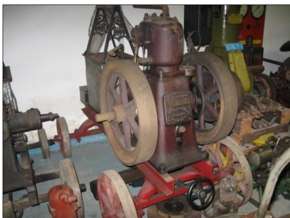
Obr. č. 17 - benzinový čtyřtakt, 4 HP, rok 1920-25. Foto: Václav Medek, 2013.
