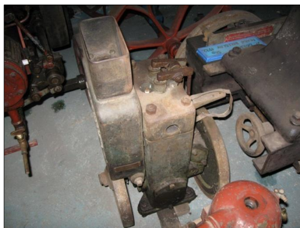
↓↓Obr. č. 15 a 16 - malý benzinový čtyřtákní rychloběžný, 4-5 HP, rok 1935. Foto: Václav Medek, 2013.
