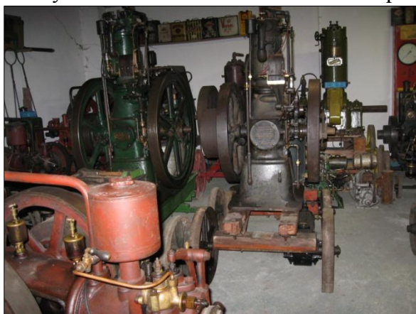
Obr. č. 31 a 32 - benzinový čtyřtakt, 3 HP, rok 1905-1910, zapalování odtrhové, nízkonapětové. Motor má automatický sací ventil - mechanicky je pomocí vahadla ovládán pouze výfukový ventil. Sací ventil má slabou pružinu a je ovládán podtlakem při sání. Foto: Václav Medek, 2013. Jedinečný, výborný motor.
