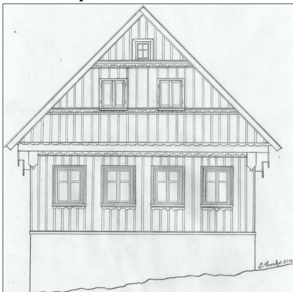
↑Obr. č. 2. Josefův Důl (okres Jablonec nad Nisou), brusírna skla čp. 922, roubená stavba typická pro Jablonecko s vertikálním obedněním. Kresba: David Veverka, 2012.
