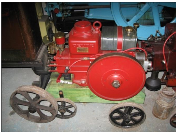
Obr. č. 45 - benzínový čtyřtakt, 3-4 HP, rok 1930, zapalování rotační magnetkou. Foto: Václav Medek, 2013.
