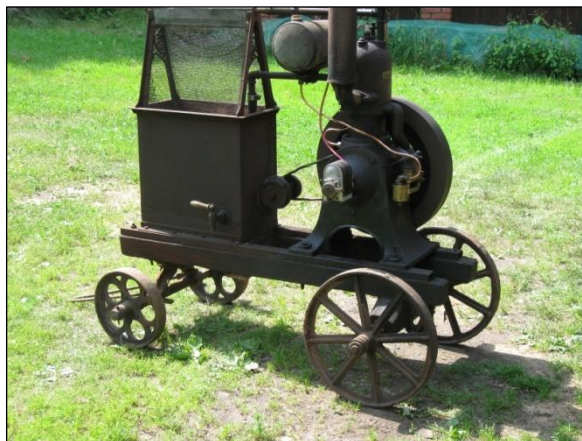
Obr. č. 27 a 28 - benzinový dvoutakt s ventilem v pístu, 4 HP, rok 1910, zapalování rotační magnetkou. Foto: Václav Medek, 2013.
