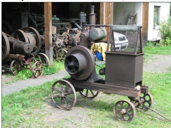
Obr. č. 27 a 28 - benzinový dvoutakt s ventilem v pístu, 4 HP, rok 1910, zapalování rotační magnetkou. Foto: Václav Medek, 2013.
