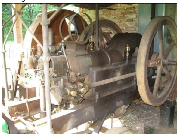
Obr. č. 20 a 21 - benzinový čtyřtakt, 8 HP, obsah 8 l, model 1910, zapalování nízkonapětové, odtrhové. Foto: Václav Medek, 2013.
