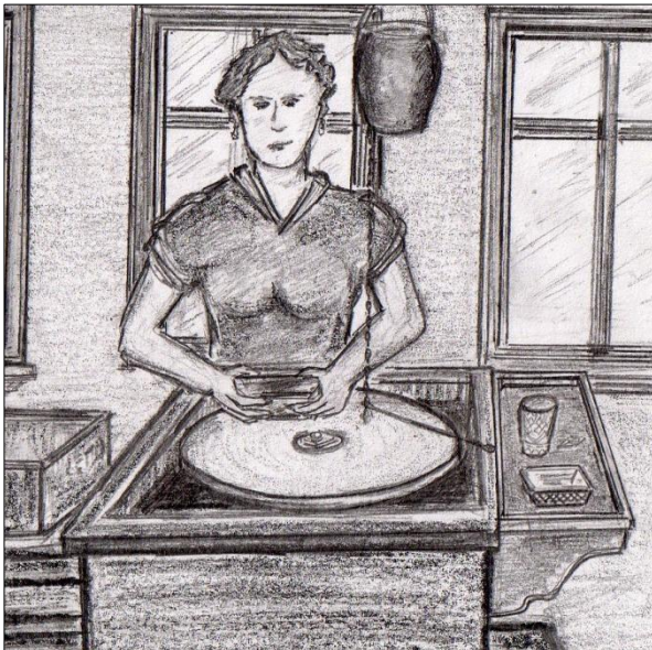
←Obr. č. 26. Práce na vertikální sklářské brusné stolič, zvané též hladinář . Kresba: David Veverka, 2012.
