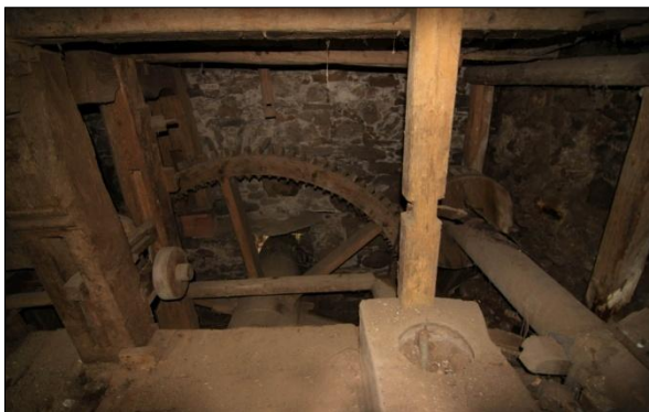
Obr. č. 14. Paleční kolo s převodem na stoupu a část štoku v Párisově mlýně čp. 6 (BN). Foto R. Šimek, 2012.
