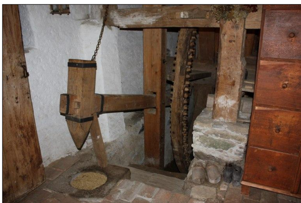
Obr. č. 7. Na svém místě dochovaný štok s atrapou kladivové stoupy ve mlýně v Hoslovicích (ST). Foto V. Vojanec, viz http://www.turistika.cz/fotogalerie/39689/stredoveky-vodni-mlyn-hoslovice (9. 12. 2013).
