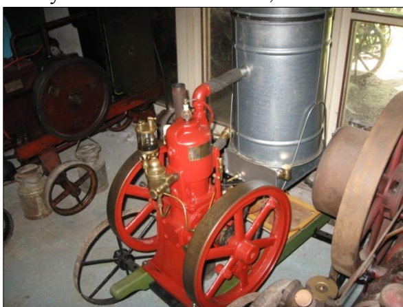
Obr. č. 38 a 39 - benzínový motor s nízkotlakým vstřikováním benzínu, rok 1910, zapalování bateriové. Motor lze reverzovat za chodu. Jedná se opět o unikát - na světě existují údajně pouze tři exempláře a z toho jsou dva kusy v USA. Foto: Václav Medek, 2013.
