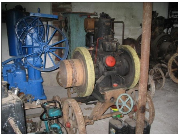
↑Obr. č. 24 - benzínový čtyřtakt, 4 HP, rok 1920, zapalování odtrhové, vysokonapěťové. Foto: Václav Medek, 2013.
