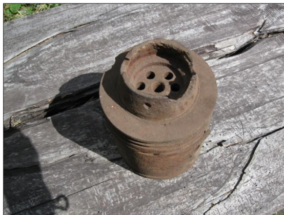
Obr. č. 29 - benzinový dvoutakt s ventilem v pístu, 4 HP, rok 1910, zapalování rotační magnetkou. Foto: Václav Medek, 2013.
