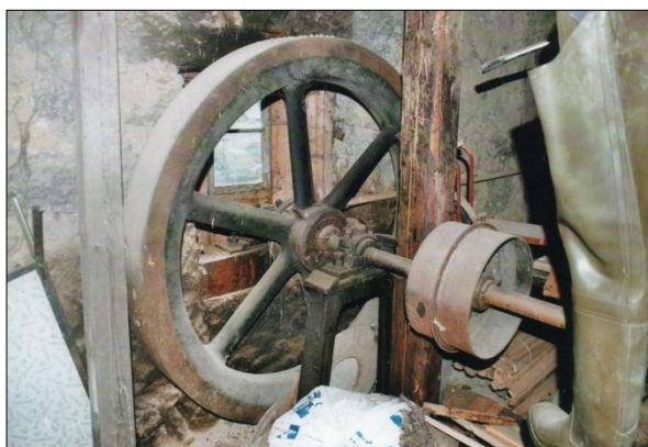
Obr. č. 19. Josefův Důl (okres Jablonec nad Nisou), brusírna čp. 887, setrvačnick na transmisi. Foto: David Veverka, 2008.
