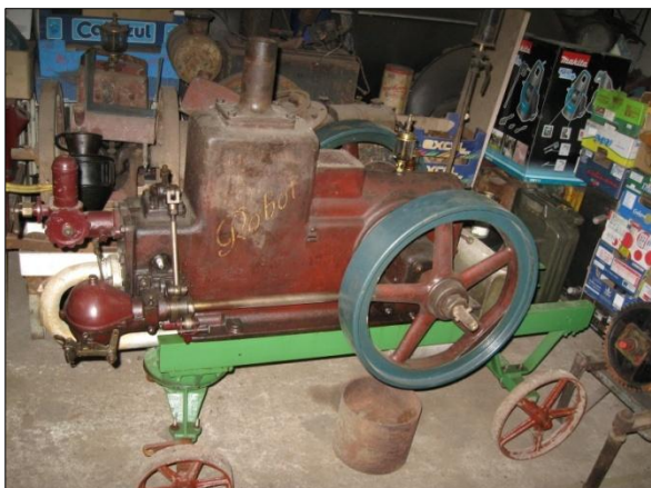
Obr. č. 22 a 23 - benzínový čtyřtakt, 4 HP, rok 1925, zapalování rotační magnetkou. Foto: Václav Medek, 2013.
