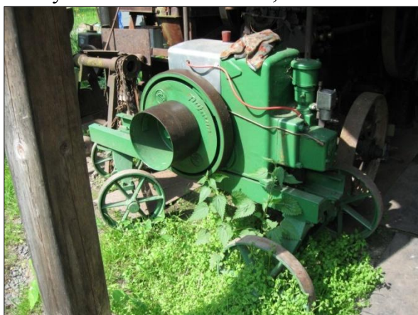
Obr. č. 49 - benzínový čtyřtakt, 5-6 HP, rok 1930-35, zapalování rotační magnetkou.
