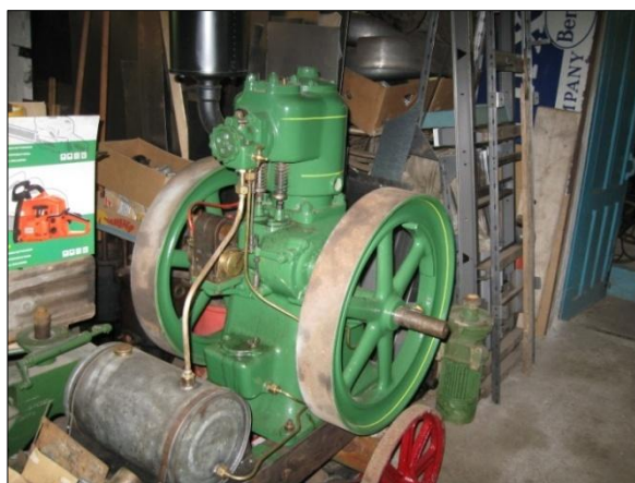
Obr. č. 17 - benzinový čtyřtakt, 4 HP, rok 1920-25. Foto: Václav Medek, 2013.
