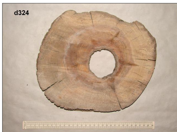
Obr. č. 8. Příbram-Mariánské údolí; dřevěné potrubí z r. 1841. Archeologický výzkum Hornického muzea v Příbrami, foto J. Kyncl.
