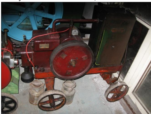
Obr. č. 48 - čtyřtaktní motor na benzín nebo petrolej, 4 HP, rok 1935, zapalování rotační magnetkou. Foto: Václav Medek, 2013.
