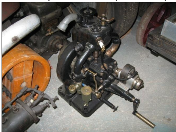
Obr. č. 8. Zapalování rotační magnetkou - motor FAFNIER, Cáchy, čtyřtákní, rok 1910. Foto: Václav Medek, 2013.
